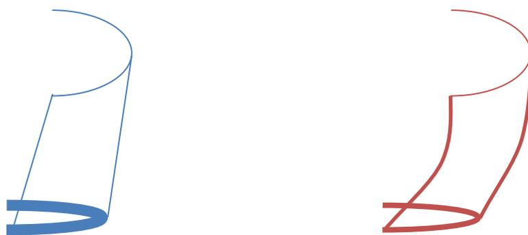
在上述「雙曲線」——兩條曲線——的意義下，德基水壩確實是臺灣水利工程的驕傲。工程界使用底部厚度對壩體高度的比值作為水壩厚薄的參數，必須小
