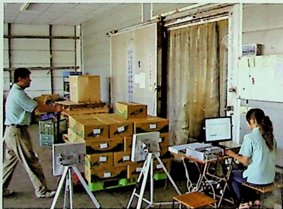
以固定式RFID設備讀取生鮮菇類產品條碼自動完成入庫作業
