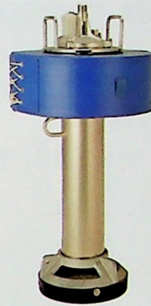
水試所開發衛星定位無線電浮標
